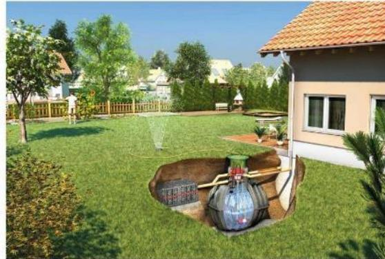
Versickerung von überschüssigem Regenwasser im Sickerschacht -> Entlastung Regenwasserleitung
